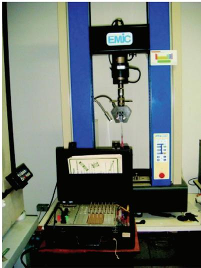
Figura 2.2 – Ensaio à tração do CFC na máquina EMIC DL 10000.
