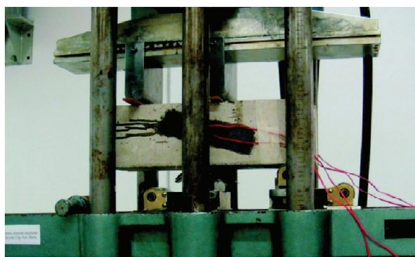
Figura 2.5 – Esquema de ensaio de cisalhamento na prensa AMSLER universal de capacidade de 500 kN realizado em 24/03/2010.
