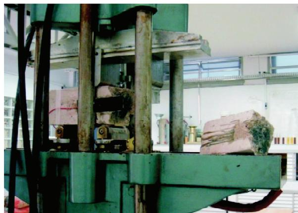
Figura 3.1 – Aspecto pós-ruptura do corpo-de-prova I 0/1; ensaio realizado em 24/02/2010.
