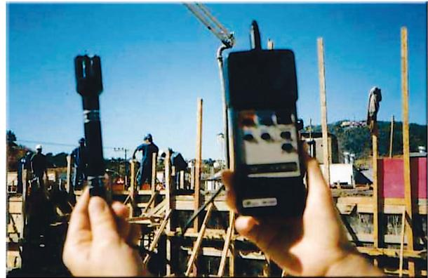
Figura 7 – Sensor 1, acoplado ao equipamento A, utilizado na medição da umidade relativa do ar e sua temperatura.
