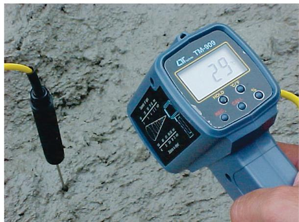
Figura 9 – Sensor 3, acoplado no equipamento B, utilizado na medição da temperatura da massa do concreto.
