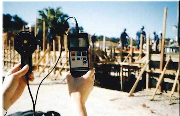
Figura 8 – Sensor 2, acoplado ao equipamento A, utilizado para medição da velocidade do vento.
