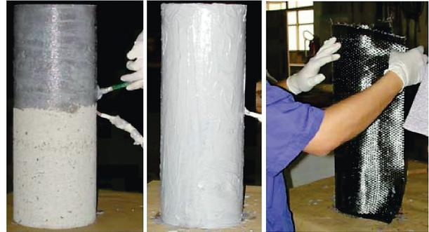
**Figura 6** – Aspectos da preparação e aplicação do encamisamento dos pilares circulares com PRFC.
