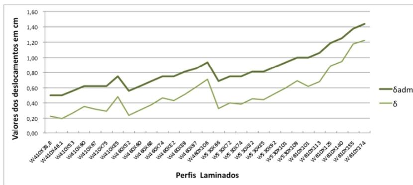
**Figura 8** – Gráfico de deslocamentos para perfis laminados.
