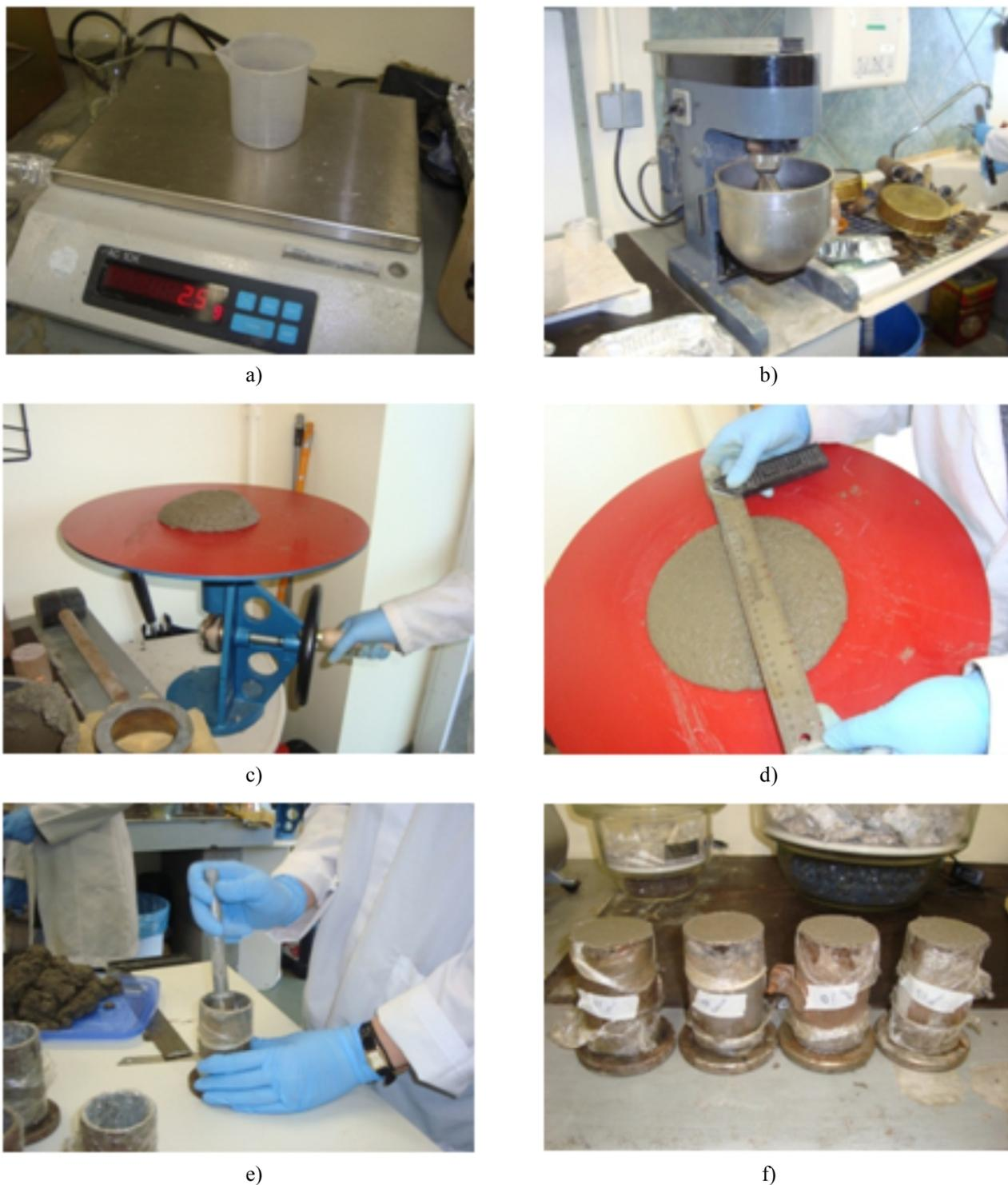
**Figura 1** – Sequência da preparação dos corpos-de-prova de argamassa: a) dosagem; b) mistura; c)flow table; d) espalhamento; e) moldagem corpos de prova; f) cura. Fonte: autor.
