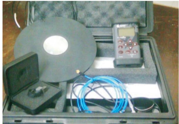
Figura 5 – Kit de Medição de vibrações VI 400-PRO (Fonte: Autor).
