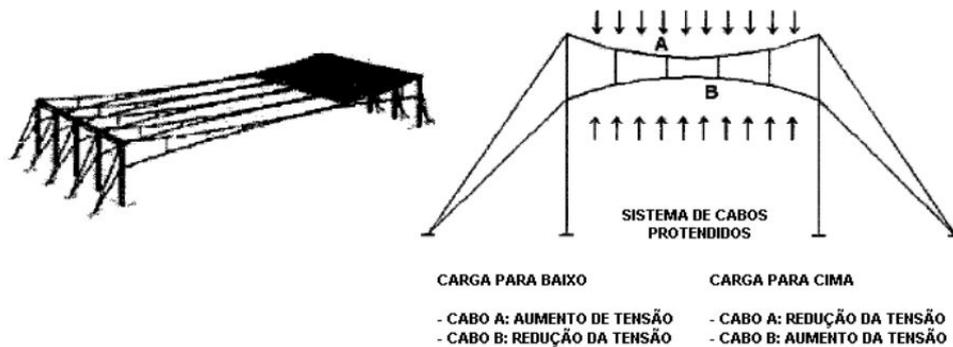
*Figura 3 – Estrutura de cabos com curvatura convexo-côncava.*
