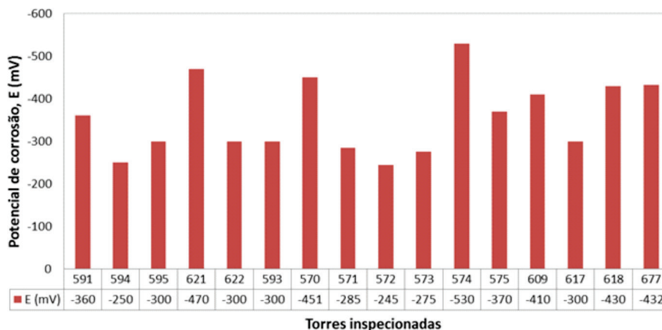
Figura 6 – Medidas de potencial de corrosão médio das quatro pernas das torres de transmissão realizadas na inspeção de dezembro de 2012.
