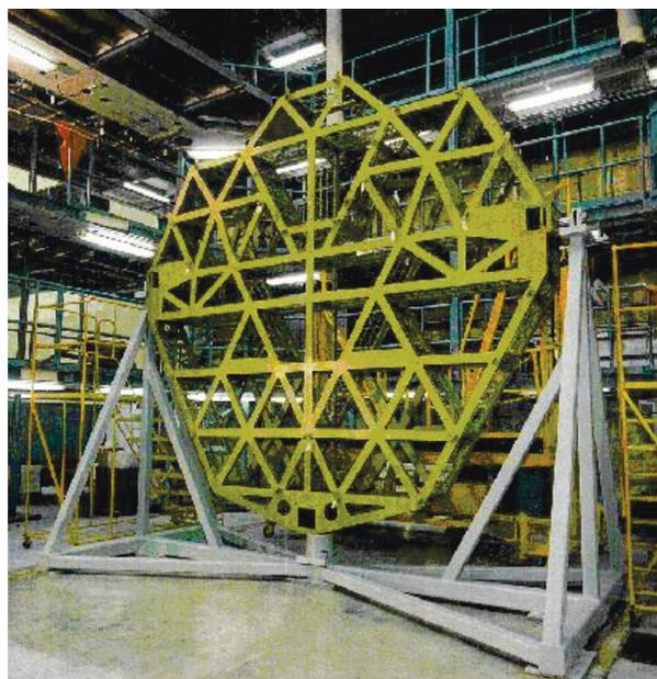
*Figura 1 – Exemplo de uma estrutura de isogrid a ser utilizada na ISS.*
