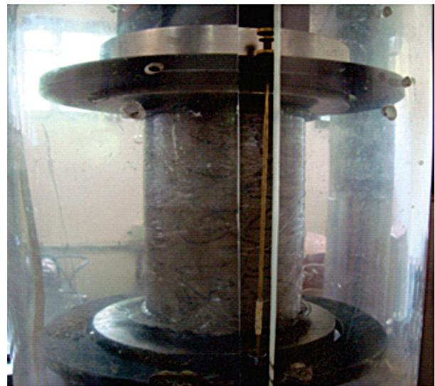
**Figura 2** – Compressômetro mecânico (a). Extensômetro elétrico de colagem superficial (b). Extensômetro elétrico de fixação externa (c). LVDT (d).
