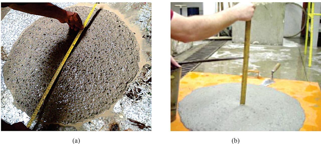
**Figura 6** – Medidas do abatimento e do espalhamento: (a) medida do abatimento; (b) medida do espalhamento no ensaio do “slump”. MARANGON, 2011.
