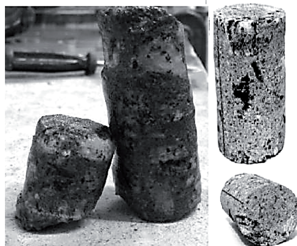
Figura 1 – Testemunhos recém-extraídos de um concreto com 30 MPa de resistência à compressão.
