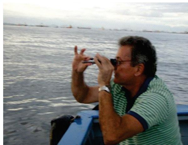
Figura 6 – Avaliação da salinidade da água com o refratômetro.
