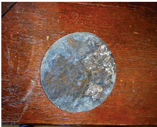
Figura 22 – Corpo de prova da camisa metálica do eixo P98A.
