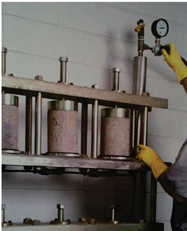
Figura 24 – Ensaio de penetração de água sob pressão.
