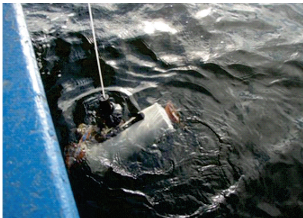
Figura 4 – Coleta de água da Baía de Guanabara, em parte profunda, mostrando a colocação inicial da “garrafa Van Dom”.
