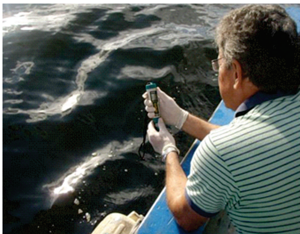
Figura 5 – Determinação do pH da água com o condutivímetro, e temperatura com multisonda.
