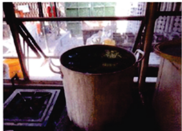
Figura 23 – Determinação da absorção de água por imersão e fervura.
