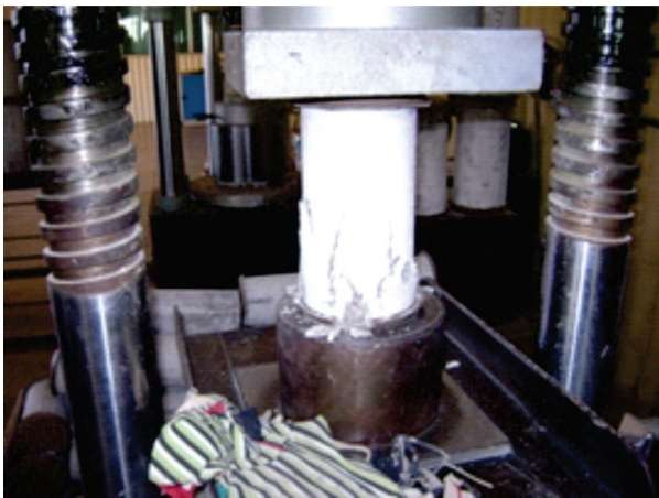
Figura 2.1 – Ensaio de resistência à compressão, realizado no Laboratório de Concreto A, localizado na região de Goiânia-GOÍAS.
