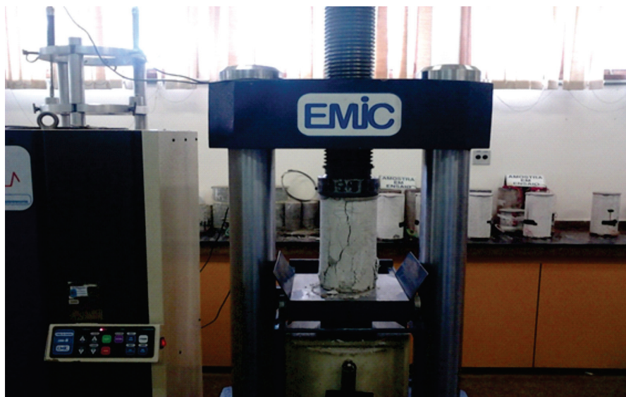
Figura 2.2 – Ensaio de Resistência à Compressão, realizado no Laboratório de Concreto B, localizado na região de Goiânia-GOÍAS.
