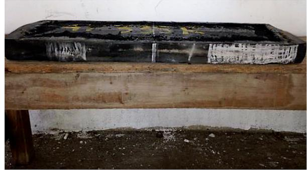
**Figura 6** – Aparência do apoio 1, após ensaio de compressão simples.
