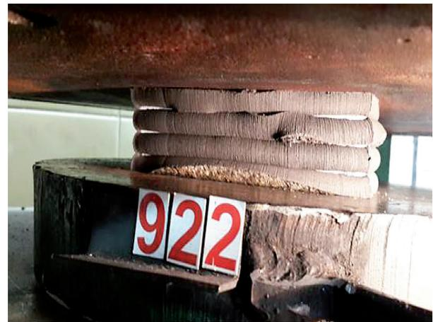
**Figura 22** – Ensaio de compressão simples em laboratório, apoio 8.
