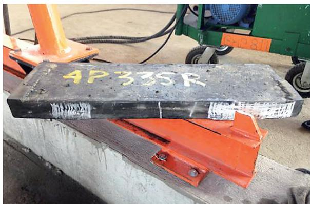
**Figura 3** – Marcação das anomalias mais relevantes das superfícies laterais do apoio 1.
