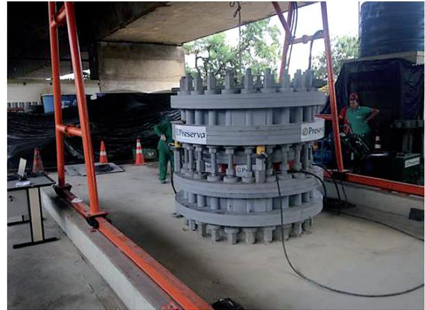
Figura 1 – Aparato de reação, construído para esta pesquisa.
