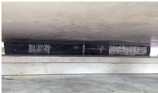
**Figura 4** – Carregamento em 15 MPa, apoio 1. Sem qualquer alteração das anomalias.
