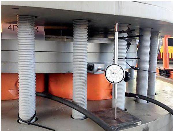
**Figura 5** – Deflectômetro instalado entre pratos do equipamento, para medir os encurtamentos dos apoios por ocasião dos incrementos de carga.
