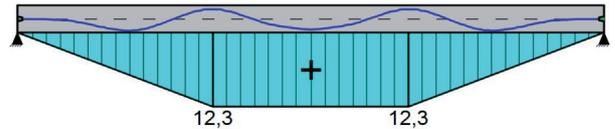
Figura 15 – Diagrama do hiperestático de protensão pelo método da carga equivalente, medidas em kN.m.
