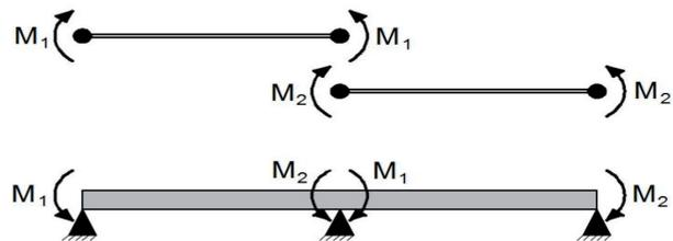
**Figura 5** – Viga contínua de dois vãos.
