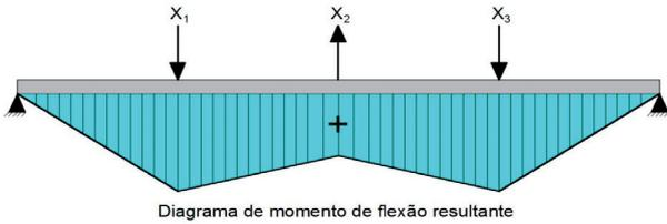
Figura 10 – Efeito do hiperestático em viga contínua de quatro vãos.
