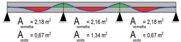
Figura 16 – Áreas entre o cabo de protensão e o centroide da seção.
