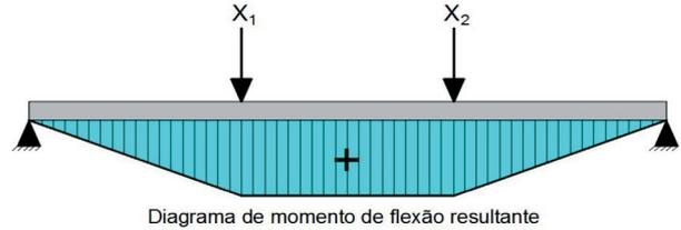
Figura 8 – Efeito do hiperestático em viga contínua de três vãos.
