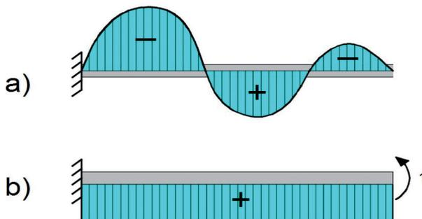
Figura 2 – Aplicação do método da flexibilidade para obtenção das forças nodais: a) diagrama de momento de flexão isostático devido à protensão; b) diagrama do momento de flexão devido à carga virtual.
