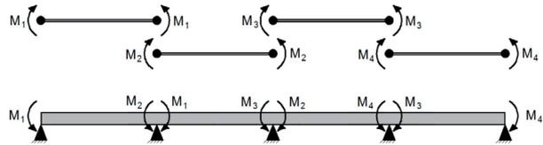
Figura 9 – Viga contínua de quatro vãos.
