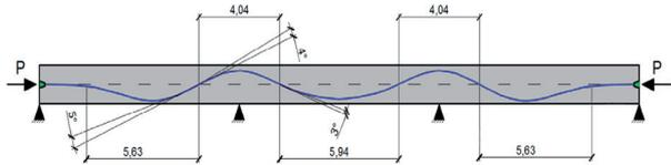
Figura 13 – Parâmetros utilizados para o método da carga distribuída equivalente, medidas em metros.
