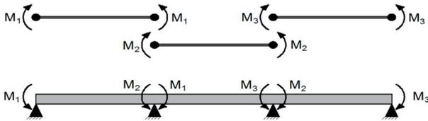
Figura 7 – Viga contínua de três vãos.
