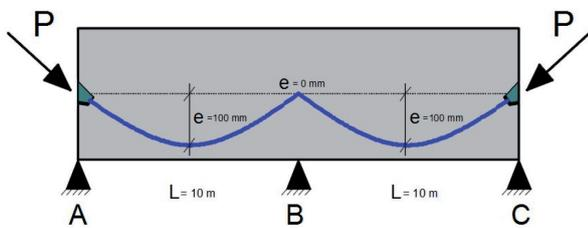
Figura 11 – Exemplo de viga contínua; adaptado de Raju (2013).
