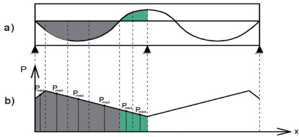
**Figura 4** – Método da carga nodal equivalente para cálculo do hiperestático de protensão: a) viga protendida simétrica; b) força de protensão atuante na estrutura.
