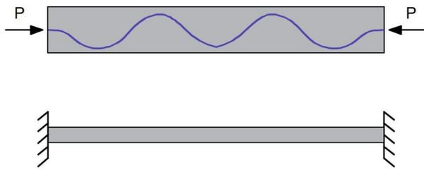
Figura 1 – Barra biengastada sujeita à protensão.
