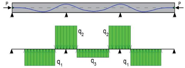
Figura 14 – Aplicação do método da carga equivalente.
