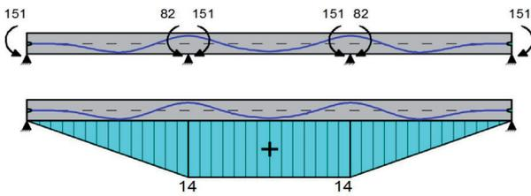
**Figura 17** – Diagrama do hiperestático de protensão pelo método da carga nodal equivalente, medidas em kN.m.
