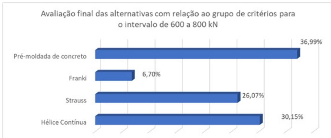
**Figura 15** – Resultados Finais para as estacas de 600 kN à 800 kN.
