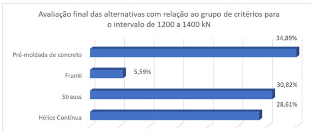
**Figura 18** – Resultados Finais para as estacas de 1200 kN à 1400 kN.
