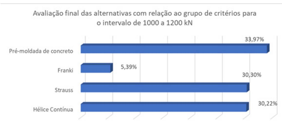
**Figura 17** – Resultados Finais para as estacas de 1000 kN à 1200 kN.
