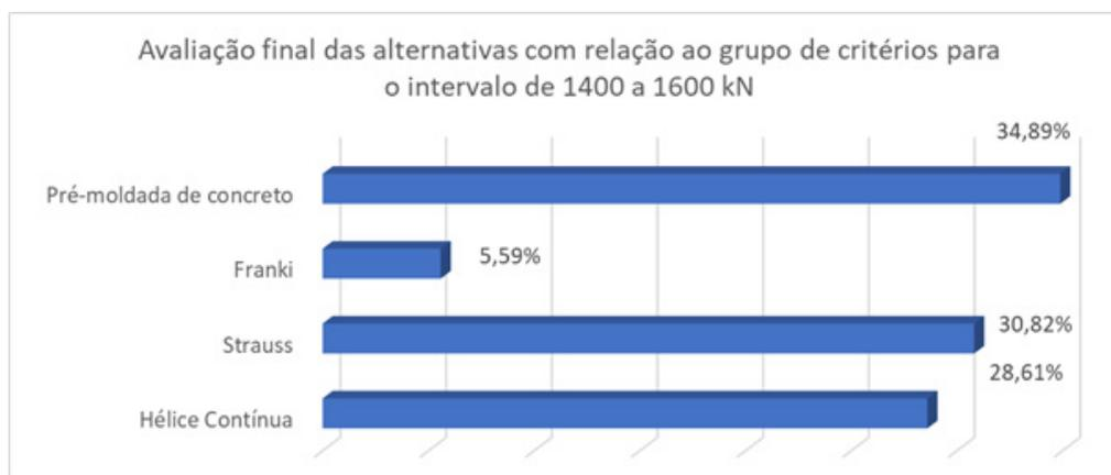
Figura 19 – Resultados Finais para as estacas de 1400 kN à 1600 kN.
