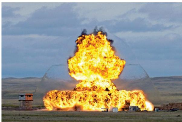
Figura 2 – Onda de choque causada por detonação.
