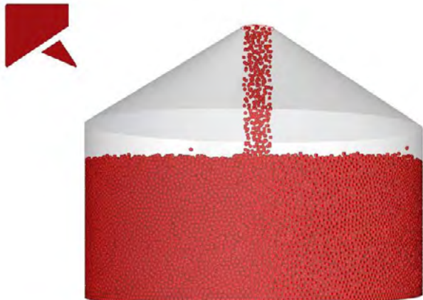
Figura 4 – Enchimento do silo através do caputo.
