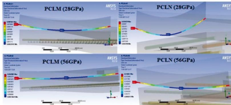
Figura 5 – Deformações na região de contato das amostras PCLM e PCLN.
