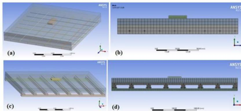
*Figura 3 – Geometrias e malhas das amostras.*
