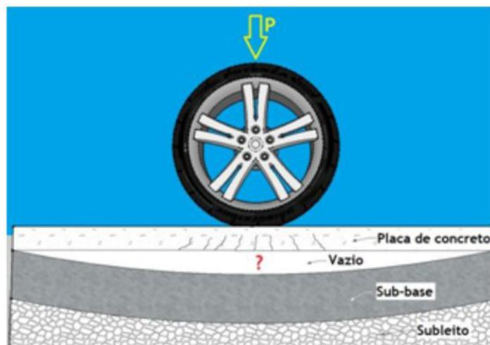
Figura 2 – Placa de concreto sujeita ao rompimento.
