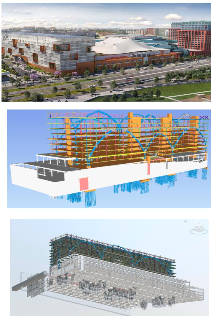
**Figura 5.6** – Nova torre de escritórios, executada sobre os edifícios existentes, em atualização; Modelação dos edifícios existentes e da estrutura metálica de suporte do novo edifício fornecida pelo Dono de Obra; Modelação das fundações do novo edifício, constituídas por microestacas
