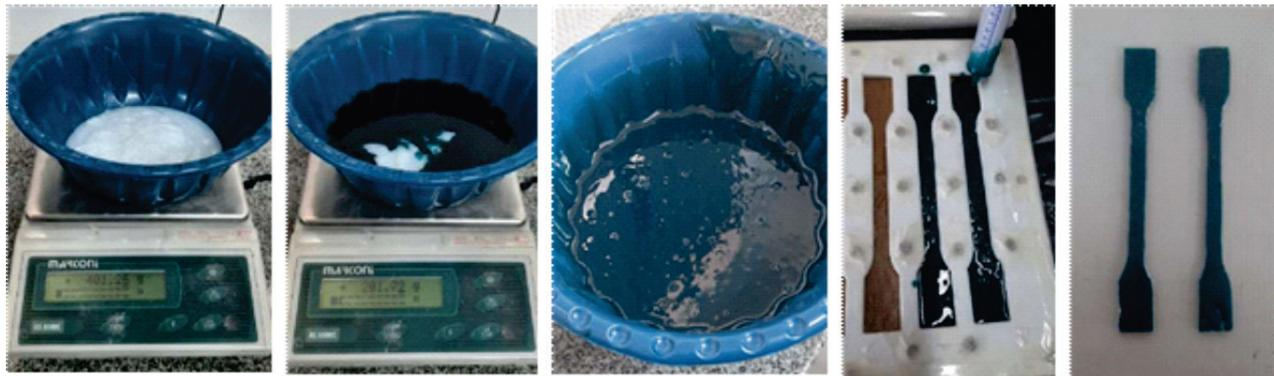
**Figura 4** – Pesagem dos componentes da resina (a-b), resina após a mistura dos componentes (c), aplicação da resina no molde (d) e aspecto final dos corpos de prova (e).
