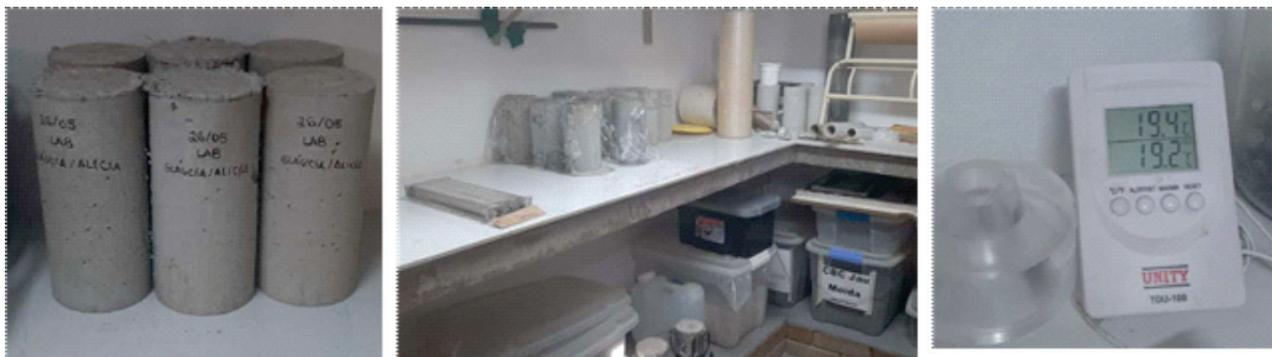
Figura 6 – Corpos de prova no ambiente laboratorial (a-b) e monitoramento de temperatura e umidade (c).
