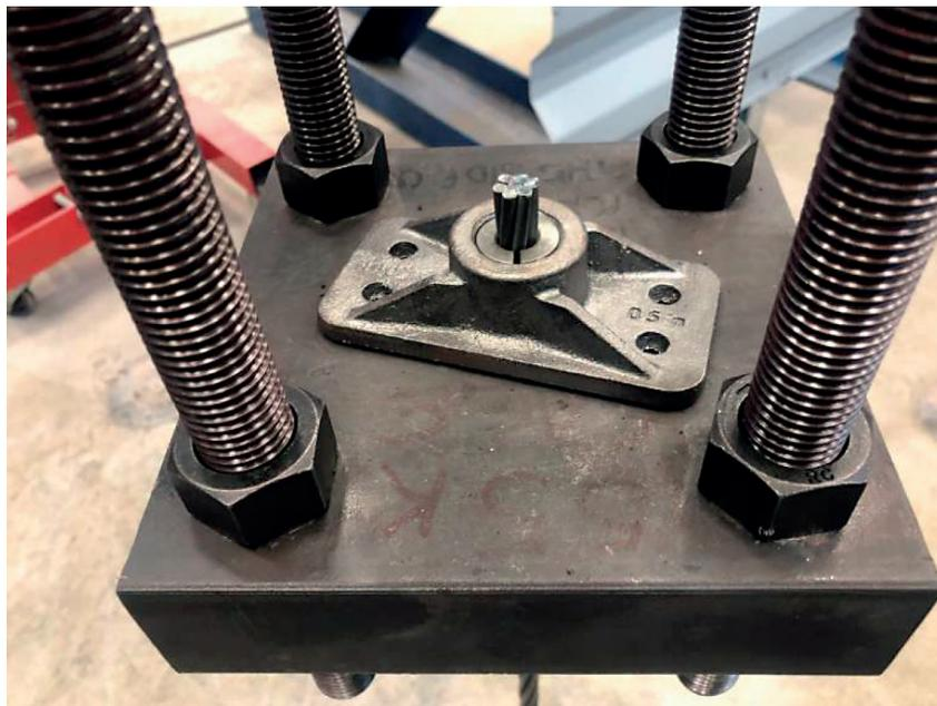
**Figura 6** – Placa de ancoragem e cunha após o ensaio de fadig
